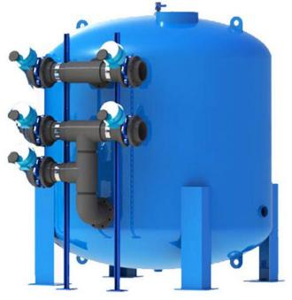
فیلتر تصفیه آب شنی در بخش پیش تصفیه در دستگاه تصفیه آب صنعتی نصب میشود. کاربرد این فیلتر در حذف کدورت و ذرات معلق آب تا سایز حداکثر ۵۰ میکرون است.
